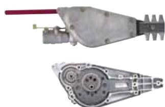
Con massima solidità costruttiva di tutti i suoi componenti, il meccanismo e le bielle sono montati su cuscinetti. Il coperchio in alluminio della scatola ad ingranaggi è fissato con 6 robusti serraggi. Bielle in acciaio con rullini per fluidità di movimento e durata.
