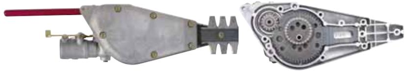
Con massima solidità costruttiva di tutti i suoi componenti, il meccanismo e le bielle sono montati su cuscinetti. Il coperchio in alluminio della scatola ad ingranaggi è fissato con 6 robusti serraggi. Bielle in acciaio con rullini per fluidità di movimento e durata.
