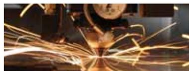
Le lame vengono tagliate al laser e vengono inoltre rettificate attraverso un processo di affilatura di precisione. Il perfetto accoppiamento delle lame è garantito da speciali pastiglie calibrate.
